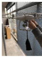
投下物装置 PGY 製 AIR DROPPING SYSTEM 重量(71g)
